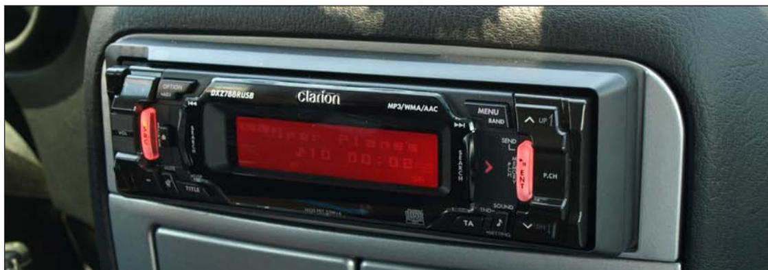
frecuencia deseada a 6 dB, 12 dB o 24 dB según el gusto o las necesidades, también equipaba el equalizador paramétrico con ajuste del Q y corrección de tiempos, características que destacan entre sus muchas especificaciones técnicas, el DXZ788RUSB con sus salidas de 6v encargadas de enviar la señal lo más nítida posible a las etapas de potencia DLS de la serie Reference RA50, una gran
